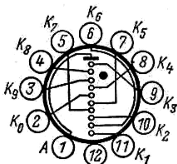
Индикатор тлеющего разряда для работы в качестве визуального цифрового индикатора электрических сигналов.
